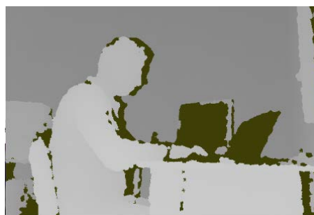
Figura 5. Imagine de adâncime captată prin intermediul senzorului Kinect
