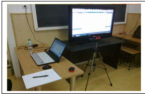
Figure 7 Sistem cu senzor Kinect pentru determinarea abaterii posturale
